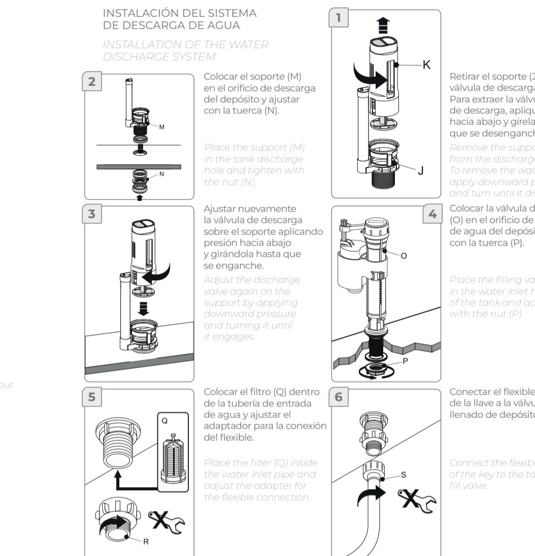
**NOTA:** El filtro opcional (Q) se coloca dentro de la tubería de entrada de agua. // Los ajustes de los puntos 5 y 6 deben ser a mano. El sobre ajuste puede dañar la rosca.
