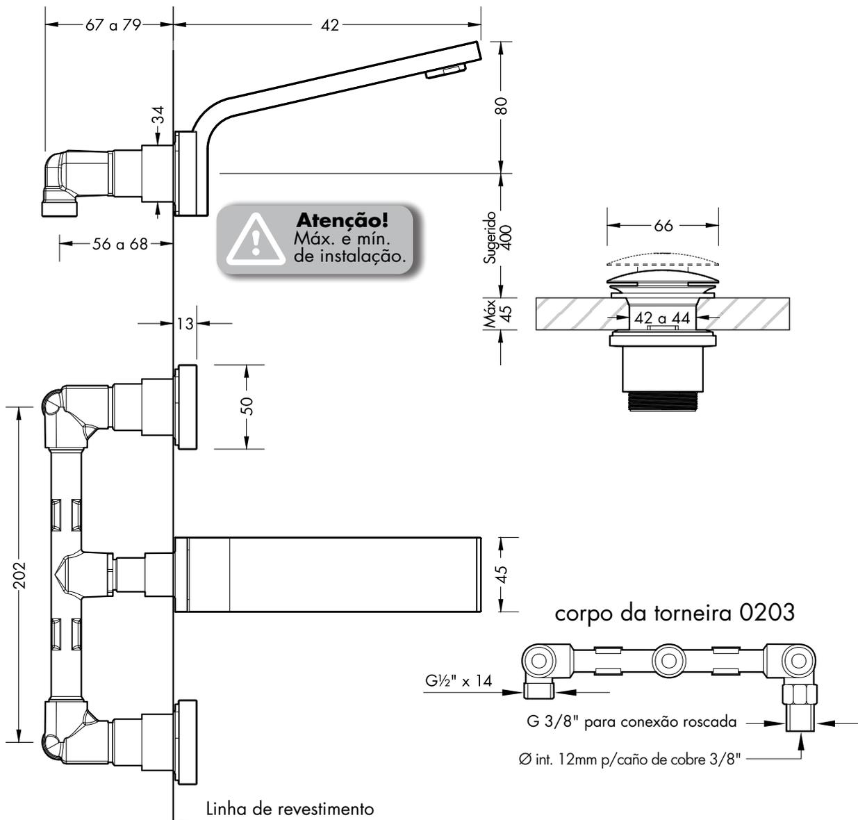
Ao posicionar a torneira na parede, preste atenção especial às medidas máximas e mínimas, bem como à medida de conexão das entradas e saídas.
