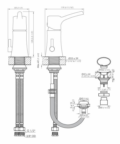
Nota: Todas las medidas están en mm y en pulgadas Note: All measurements are in millimeters and inches.
