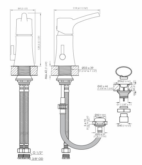
Nota: Todas las medidas están en mm y en pulgadas Note: All measurements are in millimeters and inches.
