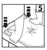
Colocar y alinear nuevamente la tapa asiento. **ADVERTENCIA:** no use limpiadores dentro del tanque. Los productos que contienen cloro (hipoclorito de calcio) pueden dañar seriamente los accesorios del tanque. Esto puede provocar fugas y daños a la propiedad.
