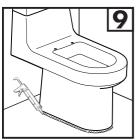
Sellar la unión entre el inodoro y el piso con un cordón de silicona. No utilizar cemento para fijar el inodoro, puede generar fisuras.
