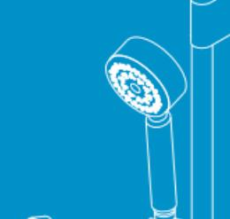
4 Fije un soporte a la pared mediante los tornillos provistos.
